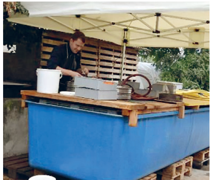
Schlammwanne mit geschlossenem Wasserkreislauf.
