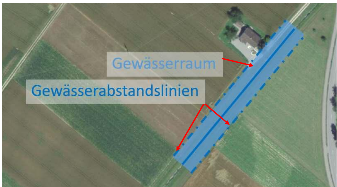
Abbildung 3: Gewässerraum als Korridor zwischen den Gewässerabstandslinien
